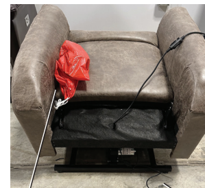
Sac contenant les composants électriques ( Transformateur électrique et cordon d'alimentation 120 volts ) Connecteur du moteur à l'arrière du bâti
