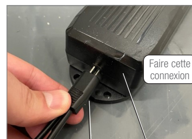
Câble en Y Transformateur électrique
