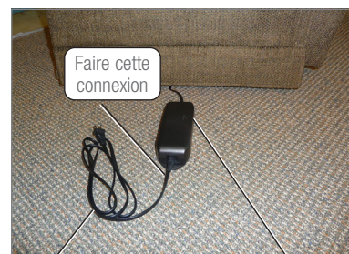
Cordon électrique de 120 volts Transformateur électrique
